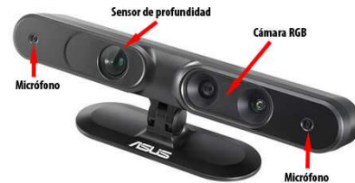
Fig. 6. Descripción del sensor Asus Xtion Pro.
